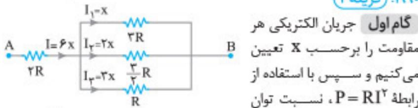
**گام اول** جریان الکتریکی هر مقاومت را بر حسب X تعیین می‌کنیم و سپس با استفاده از رابطه  $P = RI^2$ ، نسبت توان مصرفی دو مقاومت را به دست می‌آوریم. چون مقاومت‌های  $2R$  و  $\frac{2}{3}R$  موازی‌اند، اختلاف پتانسیل الکتریکی دو سر آنها با هم برابر است: بنابراین اگر جریان مقاومت  $2R$  را  $I_1 = x$  فرض کنیم، جریان مقاومت  $\frac{2}{3}R$  برابر  $I_2 = 2x$  و جریان مقاومت  $R$  برابر  $I_3 = 3x$  است. مجموع جریان‌های  $I_1$ ،  $I_2$  و  $I_3$  برابر  $I = 6x$  به دست می‌آید:
