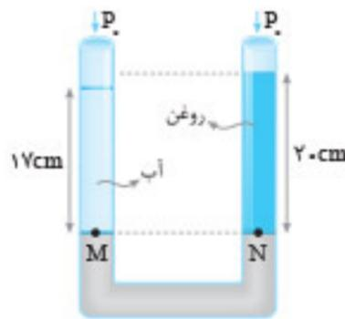
**۲۵۲. گزینه ۲** فشار درون یک مایع ساکن، در دو نقطه هم‌تراز، M و N یکسان است و داریم:
